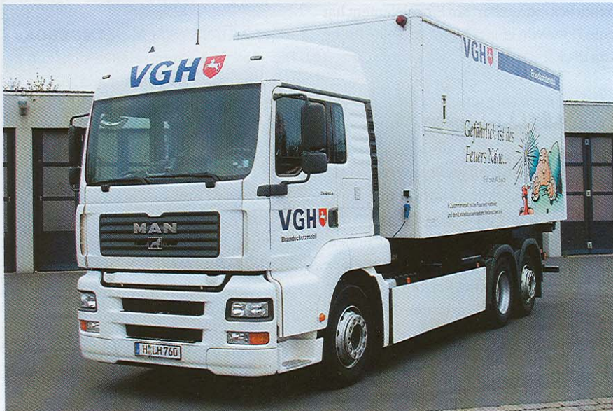
Das VGH-Brandschutzmobil ist als Wechselladerfahrzeug auf einem MAN TGA 26.410 mit Meiller-Wechselladereinrichtung konzipiert. Im Bedarfsfall kann die Feuerwehr Hannover auch bei Einsätzen auf das Fahrzeug zurückgreifen.
