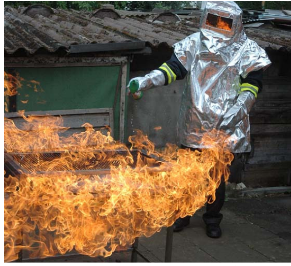
Das passiert, wenn man Brennspritus in – scheinbar – ausgeglühte Grillkohle schüttet. Der explosionsartigen Hitzeentwicklung wäre ein „Grillchef“ ohne Hitzeschutzanzug, wie ihn der Feuerwehrmann beim Experiment trägt, schutzlos ausgesetzt. Mit verheerenden Folgen.
