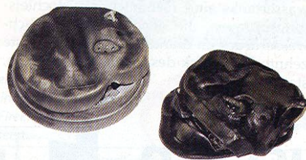
Abgebrannt: Die beiden Rauchwarnmelder aus dem Obergeschoss des Wohnhauses. Der linke Rauchmelder war im Schlafzimmer auf dem Schrank abgelegt; der rechte Rauchwarnmelder befand sich im Brandraum.
