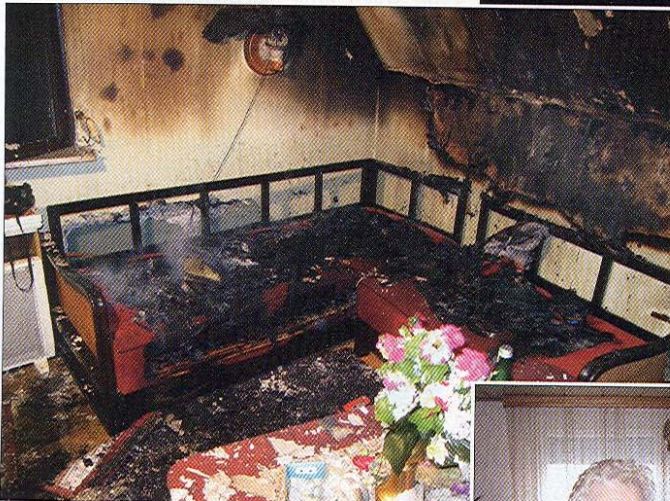
Brandherd: Brandausbruchsstelle Couch. Hier lag die eingesteckte Heizdecke, die den Brand auslöste, zum Vorwärmen.
