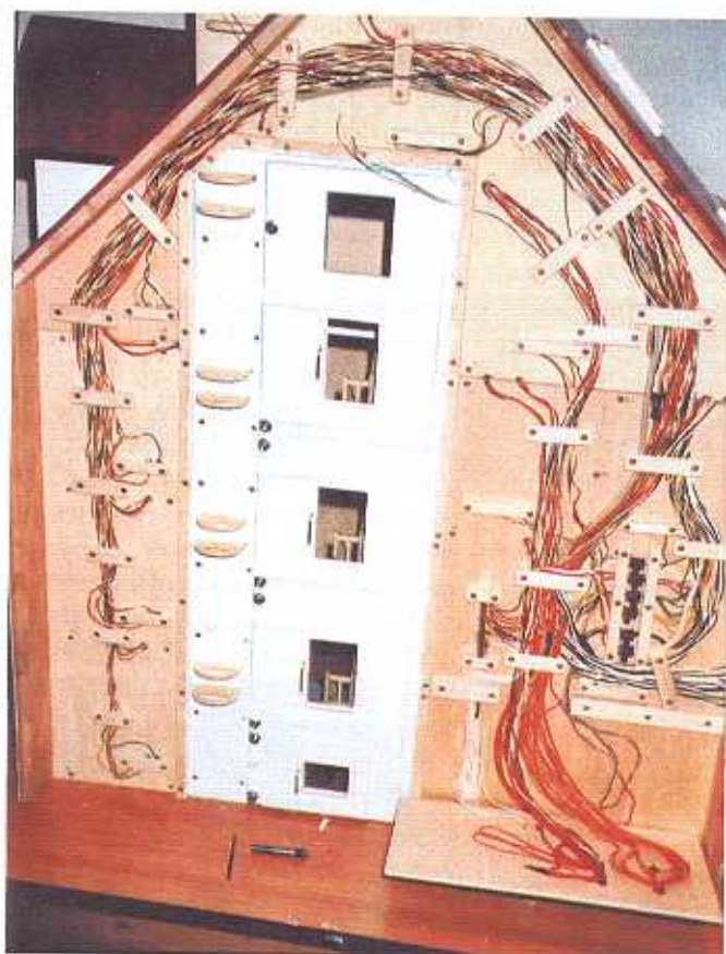
Die aufwändige Verdrahtung (das Bild entstand in der Bauphase) für die Beleuchtung, die Brandstellen, die Heizplatten, den Lüfter und die Brandmeldeanlage lässt die technischen Möglichkeiten des Modellhauses erahnen.
